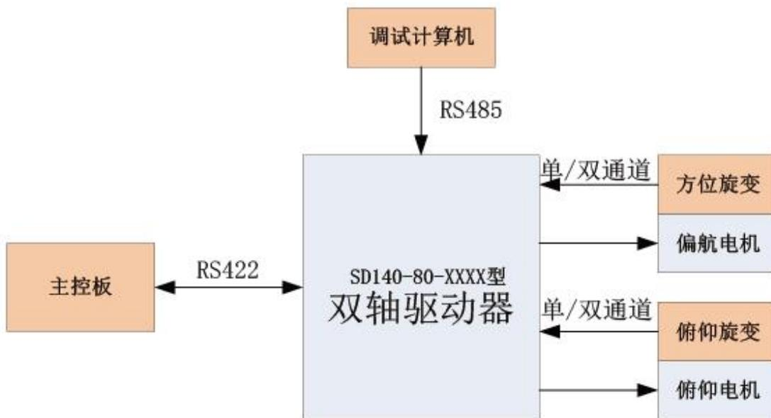
图 1 驱动器电气连接关系图
